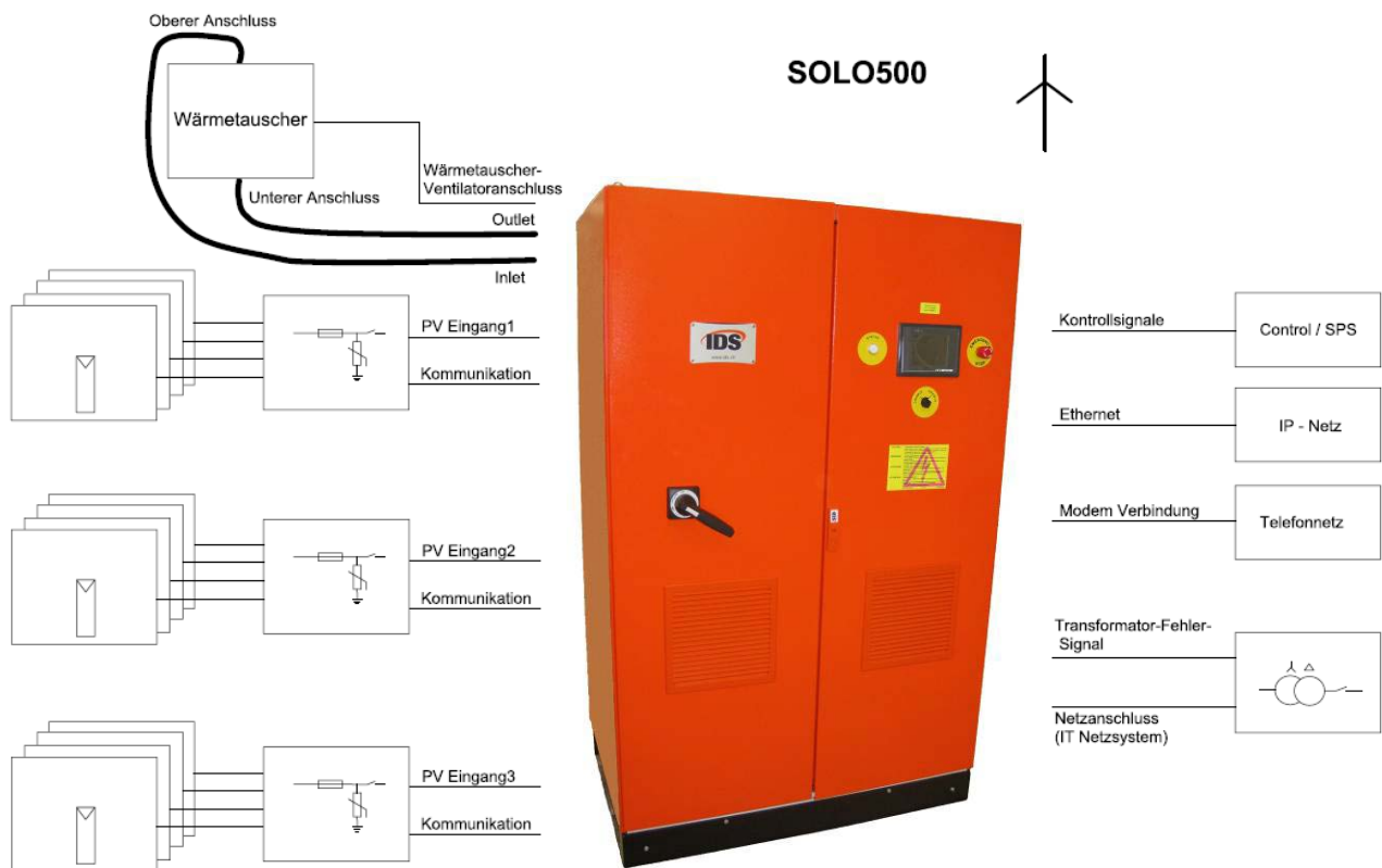
Abbildung 4.1 Übersicht einer Photovoltaik-Anlage mit SOLO Wechselrichter und SOLO String Boxen
